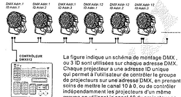
La figure indique un schéma de montage DMX, ou 3 ID sont utilisées sur chaque adresse DMX. Chaque projecteur a une adresse ID unique qui permet à l'utilisateur de contrôler le groupe de projecteurs sur une adresse DMX, en prenant soins de mettre le canal 10 à 0, ou de contrôler indépendamment les projecteurs d'un même groupe en utilisant le canal 10 du projecteur pour sélectionner l'adresse ID cible.
